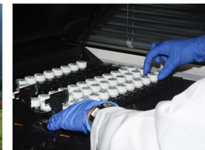
Comptage d'échantillons aqueux par scintillation liquide.
