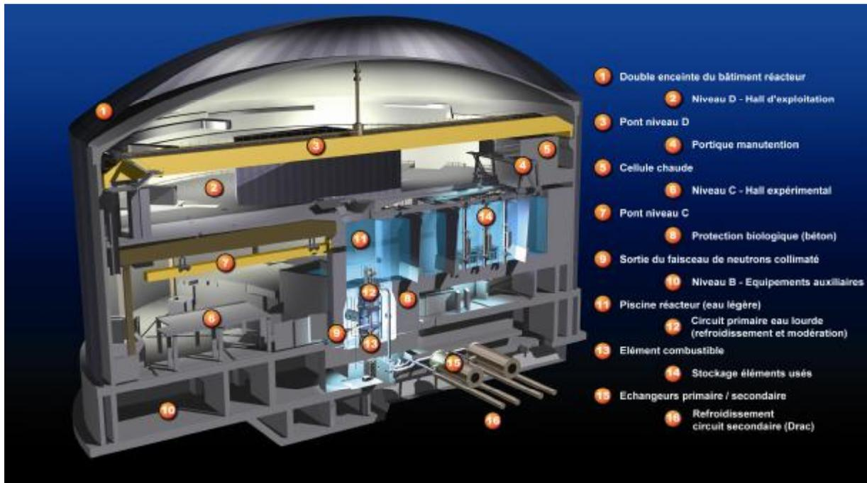
Les neutrons produits dans le réacteur par la **réaction de fission** ont une très grande énergie (vitesse : 20 000 km/s). Ils sont ralentis par l'eau lourde afin de pouvoir à la fois provoquer de nouvelles fissions pour entretenir la réaction en chaîne (neutrons thermiques dont la vitesse est de 2,2 km/s) et alimenter les dispositifs expérimentaux des scientifiques.
