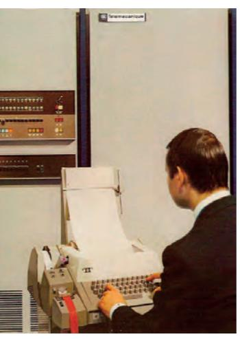
Un télémécanique T2000 construit à Echirolles, France. Le terminal est une Teletype ASR 33.
