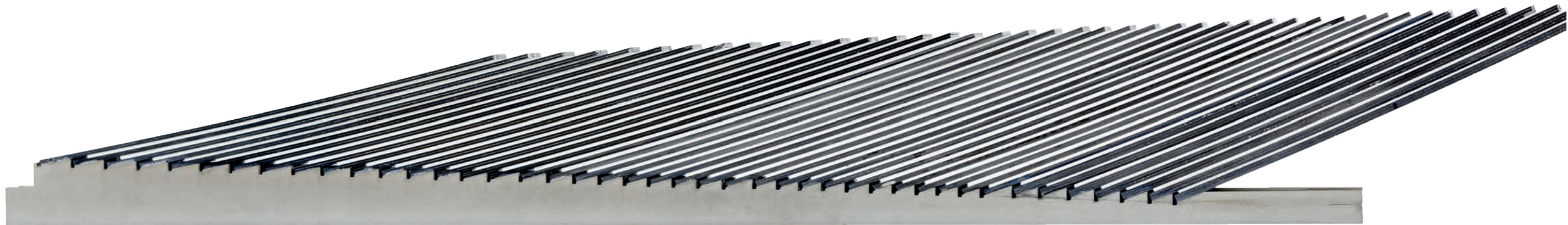
Vue de profil d'une cassette unité de Marmot, mettant en évidence l'alignement quasi parfait de 43 ensembles, chacun constitué de deux lames de Si(111) courbées plastiquement (longueur totale : 50 cm).
