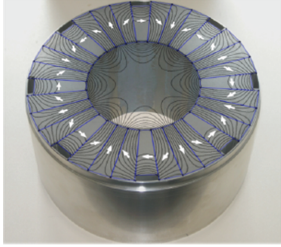
Figure 2.3 – Photo d’un module d’aimants permanents constitué de 32 aimants arrangés en hallbach array produisant le champ octupolaire
