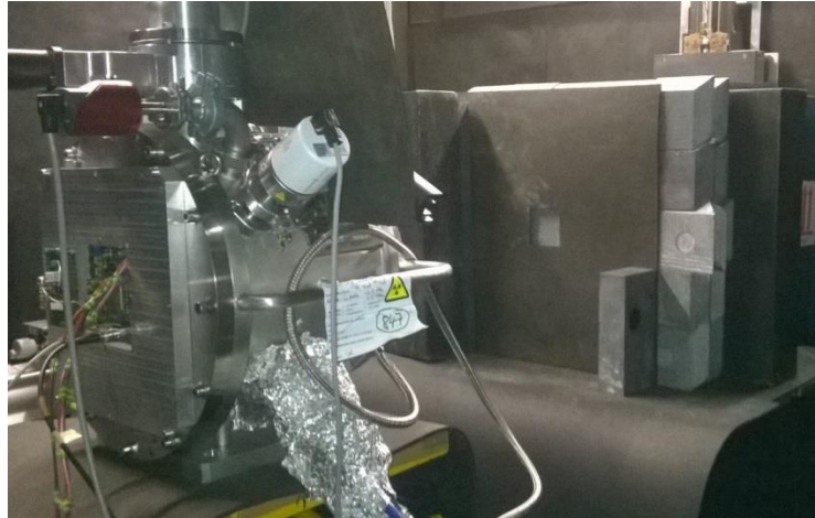
Figure 122. Détecteur \mu\text{TPC} dans la casemate de l'ILL pour la détection des neutrons du réacteur. La fenêtre en face est blindée en plomb (briques grises) et en bore-10 (feuilles noires) pour atténuer le nombre de \gamma et de neutrons thermiques.
