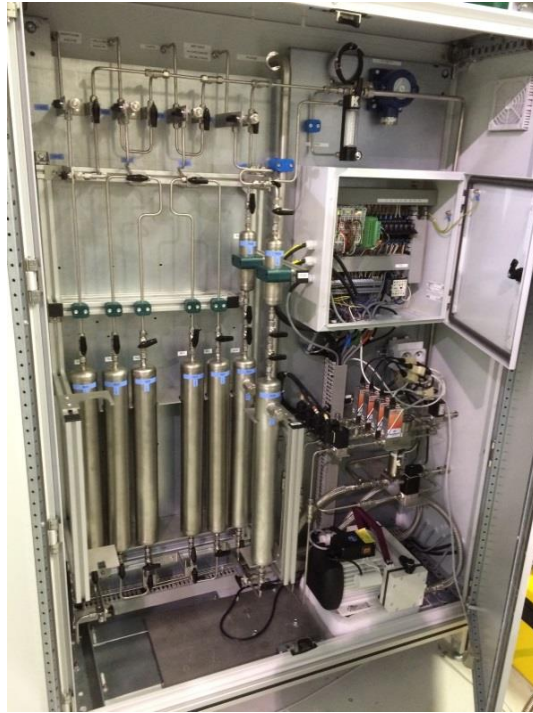
Figure 47. Système de régulation du mélange gazeux, modifié avec l'ajout de filtres supplémentaires et de nouvelles connectiques.
