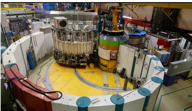
Abbildung 11: Neutronendiffraktometer D20 am Institut-Laue-Langevin (Grenoble, Frankreich). Links: Übersicht über das Instrument. Rechts: Stahlgalgen zur Positionierung der Vanadium-Zylinder im Neutronenstrahl, Blenden aus absorbierendem ^{10}\text{B}_4\text{C} begrenzen die zu bestrahlende Stelle.
