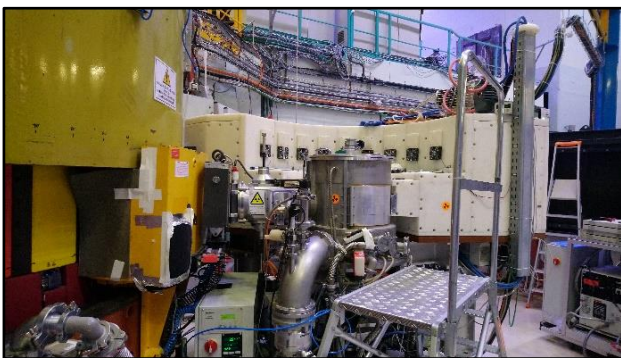
Abbildung 10: Neutronendiffraktometer D4 am Institut-Laue-Langevin (Grenoble, Frankreich). Links: Frontansicht mit evakuierbarem Stahlbehälter für die Messungen. Rechts: Rückansicht des Detektors mit Steuerelektronik.
