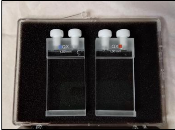
Abbildung 129 (links): Hellma-Zellen aus Quarzglas mit PTFE-Stopfen verschlossen und gefüllt mit \text{Li}_2\text{SO}_4 -Lösung. Die Schichtdicke der Lösung beträgt 1,00(1) mm.
