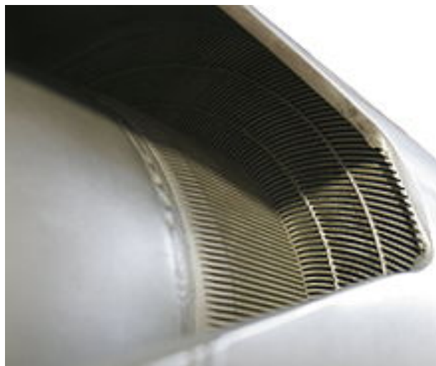
Abbildung 3.1.2: Einblick in das Innere eines leeren Brennelementbehälters. Innerhalb der Lamellen befindet sich normalerweise das hoch angereicherte ^{235}\text{U} . 3
