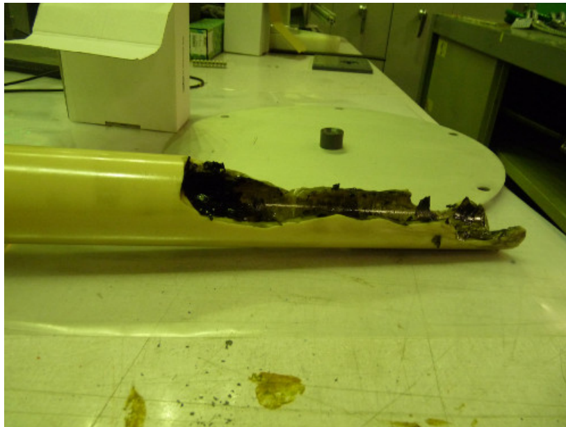
FIGURE 5.4: Connecteur cassé de la haute tension
