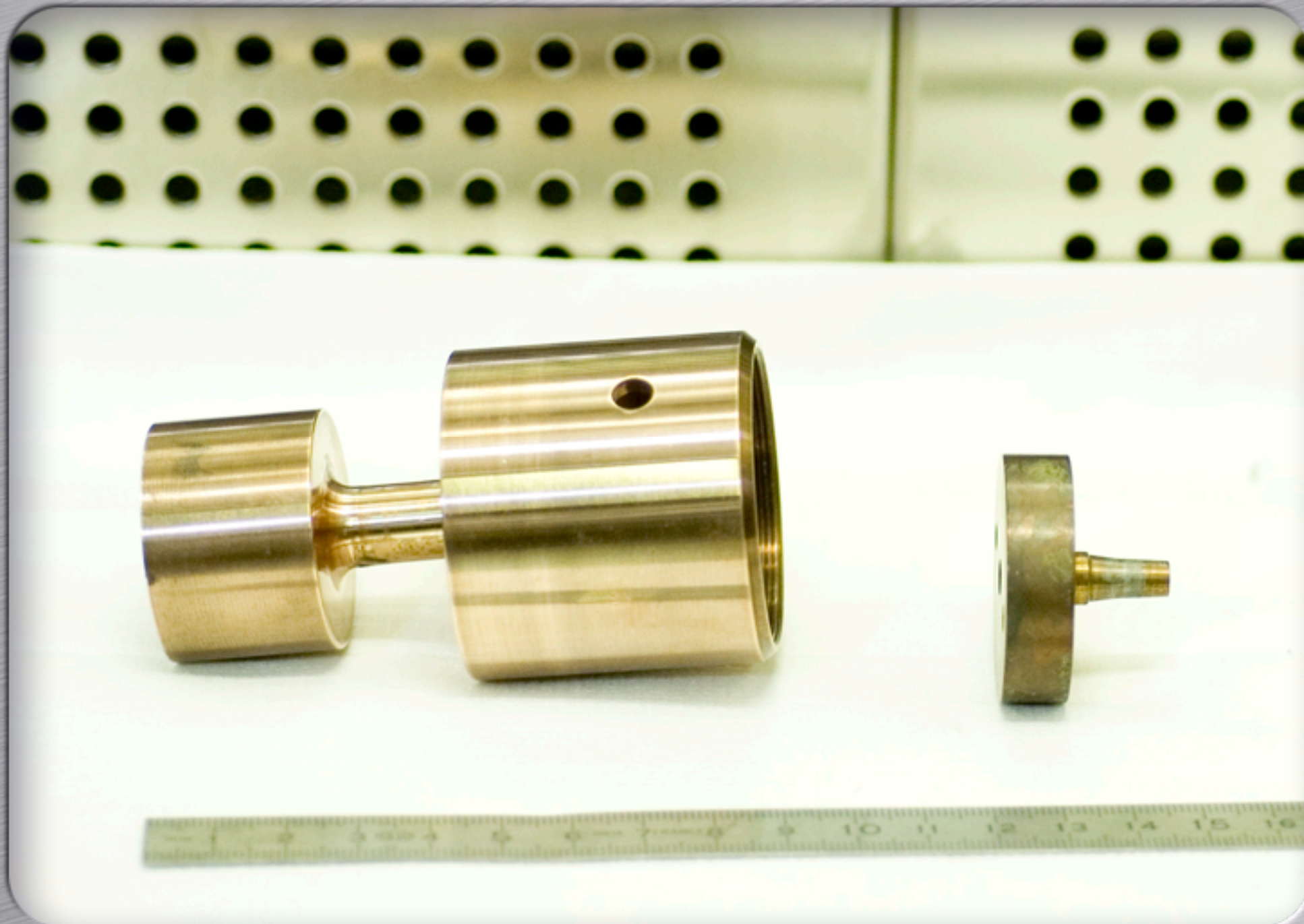
Cellule 5kbar à 300K, 3 kbar à 500K
