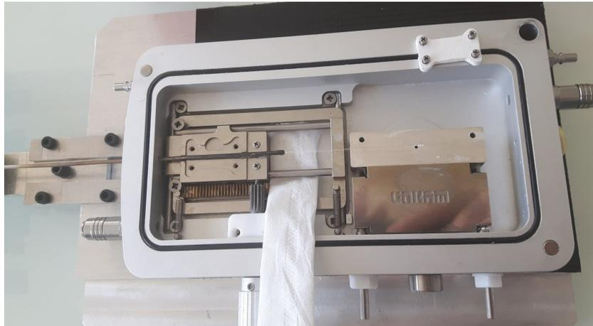
Figure 2.12 : Capillaire collé (en cours de séchage) dans la cellule Linkam capillaire pour les études in-situ.
