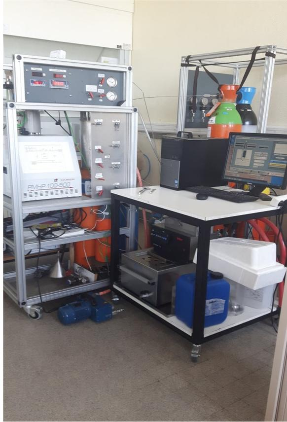
*Figure 2.9 : Montage expérimental pour la formation d'hydrates de gaz. Il est constitué d'un bain d'huile siliconée (ou mélange eau/éthanol) permettant de réguler la température des échantillons, d'une pompe seringue contenant le gaz (ou mélange de gaz) et connectée à un ordinateur, permettant de réguler la pression dans les cellules échantillons.*
