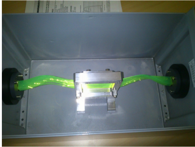
FIGURE 84 – Prototype du réseau de fibres optiques.
