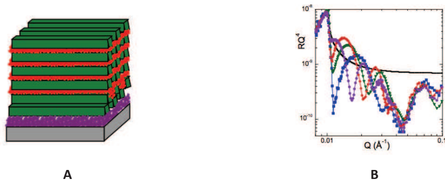
Figure 2 : Représentation schématique d'un films (NCC/PAH) (A). Spectre de réflectivité en représentation RQ^4 d'un film (NCC/PAH) _m avec m = 1,5 (■), 2,5 (▼), 4 (◆), 5,5 (●)
