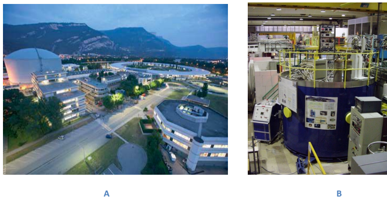
Figure 2: A - Vue de l'ILL avec son réacteur à gauche de l'image. B - Spectromètre neutronique à rétrodiffusion IN13 (températures de 5 à 550K et pressions de 1 à 7kbar).
