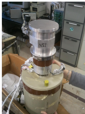
FIGURE 2.12: Les détecteurs en silicium et leur réservoir commun.
