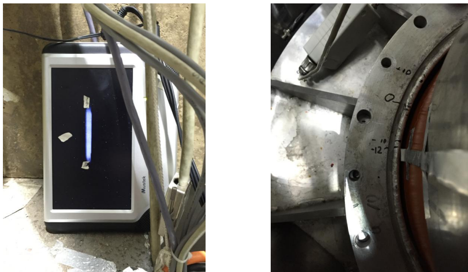
Figure 8.6: A gauche, photo de l'image de la caméra lorsque le faisceau est aligné avec la cellule. La largeur de l'intensité lumineuse est alors la plus grande. A droite, photo du repère que l'on a effectué sur le cryostat grâce aux trous de vis.
